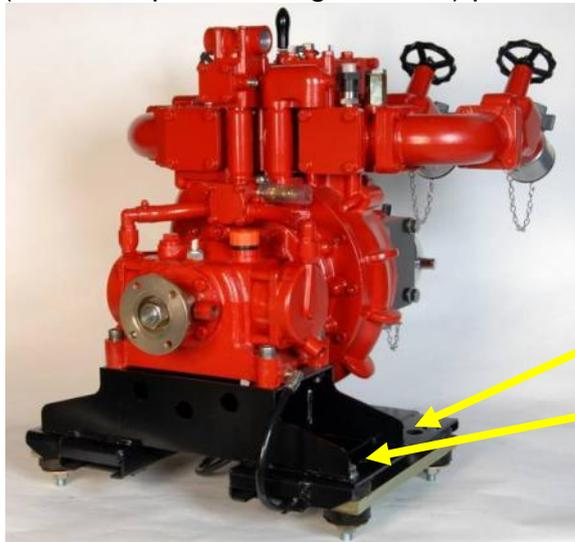
Puntos de fijación de tornillos – M16, tornillos de cabeza de alta tracción, (cuatro)
