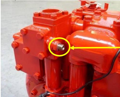
Toma para manómetro de alta presión, Rp 1/4"
