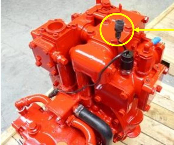
Conectar este cable del presostato a la luz en el panel de instrumentación opcional para luz o control manual.
